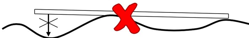
Zur Bestimmung der Ebenheit können Anfangs- und Endpunkte der Messungen frei gewählt werden. Bei schwimmenden Zementestrichen müssen laut Norm SIA 251:2008 die Anfangs- und Endpunkte wegen der Schüsselung in einem Abstand von mindestens 1 m von den Ecken und von mindestens 0.5 m von den Wänden und den Fugen entfernt aufgesetzt werden:
