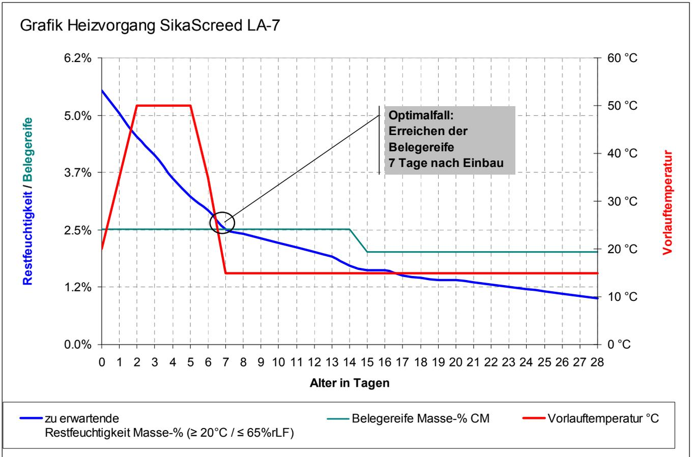
Heizvorgang: Während den Einbauarbeiten darf / soll die Heizung mit +20°C Vorlauftemperatur laufen. 24 Stunden nach Beendigung der Einbauarbeiten beginnend die Temperatur täglich um 15°C steigern bis max. Vorlauftemperatur 50°C. Ab dem 3. Tag 3x täglich Stosslüften! Nach Erreichen der Belegereife (CM-Messung) kann die Vorlauftemperatur täglich um 15°C gesenkt, bzw. der Boden anschliessend belegt werden.
